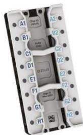
Stilla社のCrystal Digital PCR®テクノロジーは、最新のマイクロ流体技術により、核酸の絶対定量を可能にします。この革新的な技術により、デジタルPCRプロセスはチップ1つに統合され、サンプルをセットするだけで結果が得られる簡便性を実現しています。
